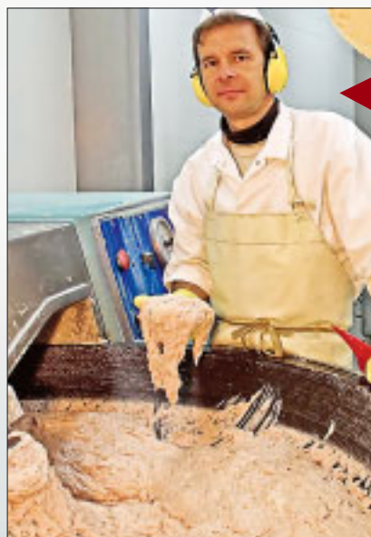
Kutterissa liha ja makkaran muut valmistusaineet sekoitetaan tasaiseksi massaksi leikkaavien terien avulla. Perniön lihan tuotantopäällikkö, elintarvikeinsinööri Jyri Eeronaho kutteroimassa.
